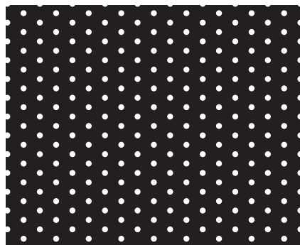
Nr. 4352 (Rv 1,1 - 3,5 / 90°) mm Lochweite \varnothing 1,1 Teilung horizontal 3,03+3,03 Teilung vertikal 3,5 Durchlass 9 % Perforation 90° gedreht
